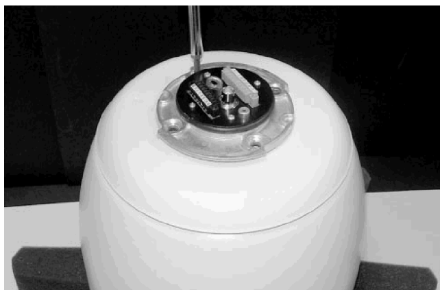
Fot. 1D. Montaż górnej płytki
